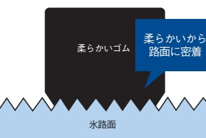
氷の路面でもスタッドレスが滑りにくいのは路面に密着するようにゴムを柔らかくしているからです。スタッドレスは寒冷地でも、柔らかさを保つことができる専用のゴムを採用しています。
