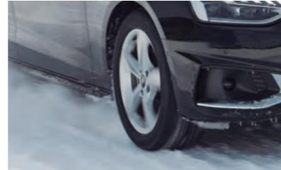
今までの技術では難しかった冬性能とロングライフの両立を達成。ライフ向上のため、均一摩耗タイヤ形状を採用し偏摩耗を抑え、コンパウンドの柔軟持続性を向上させる軟化剤を採用。
