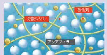
柔軟性を高める極小分散シリカを採用し、路面への高密着を実現。さらに、柔軟持続性を向上させる軟化剤を採用。
